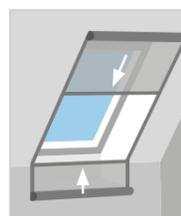
Les fenêtres comportant des éléments verticaux requièrent deux moustiquaires. Une moustiquaire est tirée de haut en bas, tandis que l'autre est fixée sur l'appui de fenêtre et sera tirée de bas en haut. Un joint en caoutchouc assurera une jonction étanche. Ce dernier est à commander séparément: type Z0Z 157 - prix: 12€ hors T.V.A.
