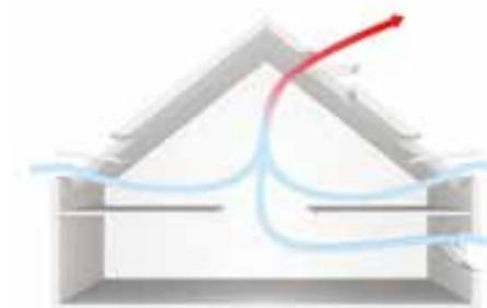
Les fenêtres de toit vous permettent de créer un effet de cheminée pour garantir une aération optimale.
